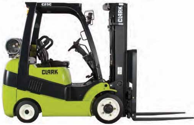
C20C/25C/30C/32C LPG Gabelstapler mit Verbrennungsmotor und Cushion-Bereifung 20 25 30 32 2000 2500 3000 3200 KG
