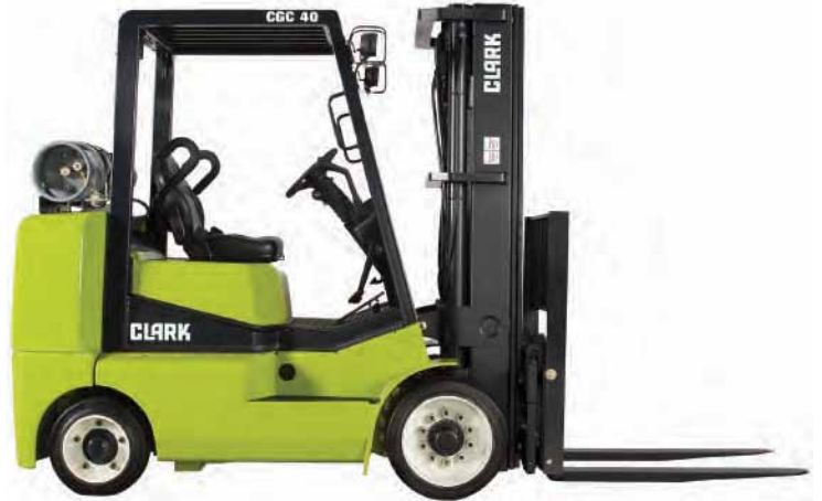
CGC 40/50/55 LPG Gabelstapler mit Verbrennungsmotor und Cushion-Bereifung 40 50 55 4000 5000 5500 KG
