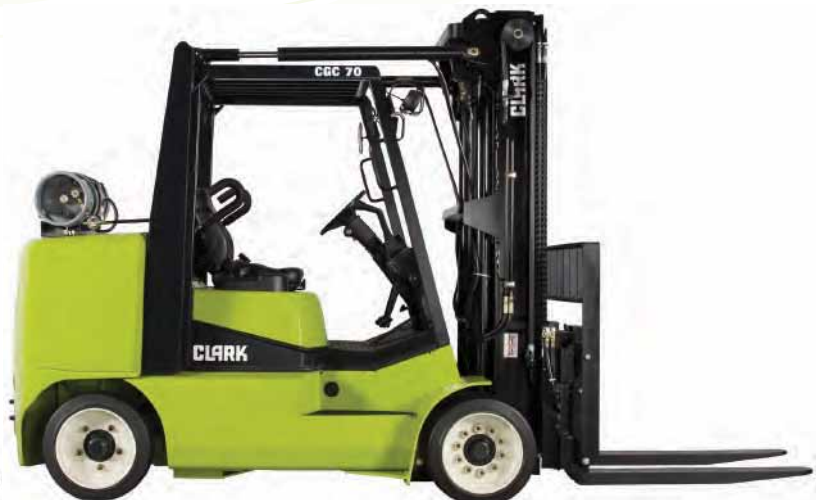
CGC 60/70 LPG Gabelstapler mit Verbrennungsmotor und Cushion-Bereifung 60 70 6000 7000 KG
